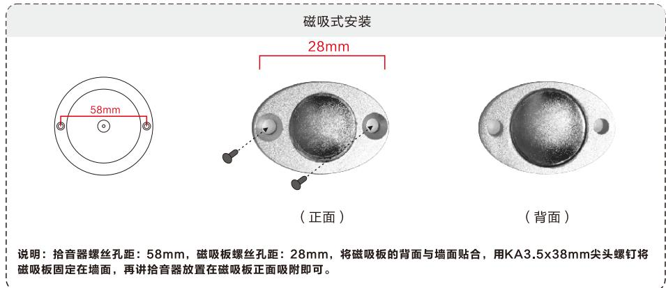
说明：拾音器螺丝孔距：58mm，磁吸板螺丝孔距：28mm，将磁吸板的背面与墙面贴合，用KA3.5x38mm尖头螺钉将磁吸板固定在墙面，再将拾音器放置在磁吸板正面吸附即可。
