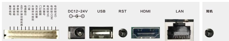
(1) 网络接口 (LAN)：通过网线插入到路由器LAN端(或交换机)任一端口上。
